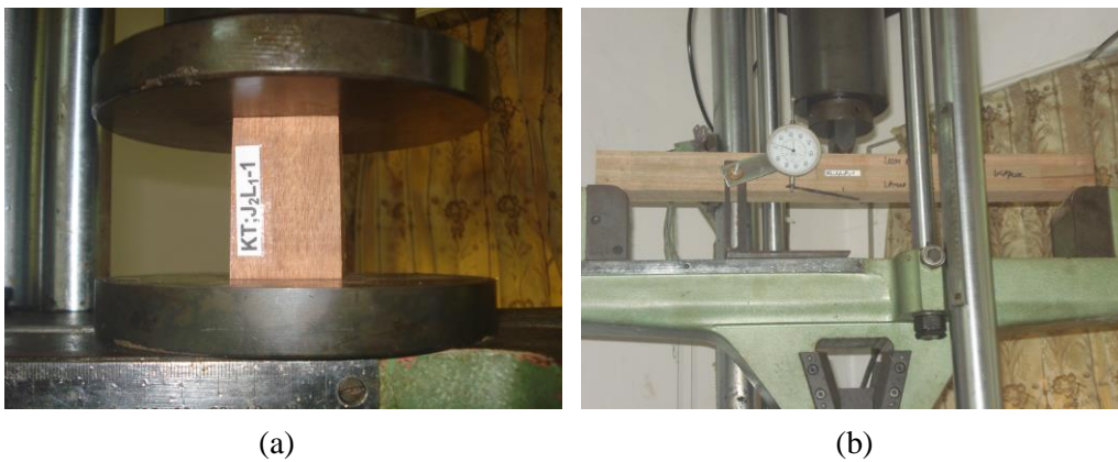
Gambar 5. (a) Proses uji kekuatan tekan; (b) Proses uji kekuatan MOE, MOR
