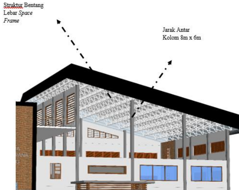
Gambar 4. Penerapan Struktur Bentang Lebar pada Bangunan
