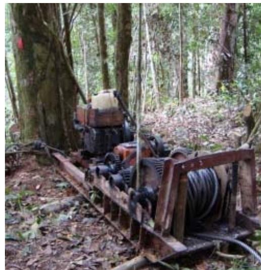
Gambar 1. Mesin Pancang Tarik (Mesin Monocabel)
