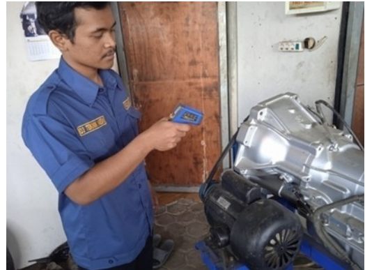
Gambar 4. Proses pengecekan suhu pada body transmisi otomatis
