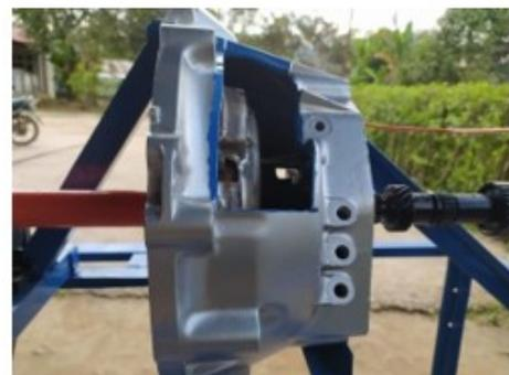
Gambar4. Pemasangan Housing Pada Stand
