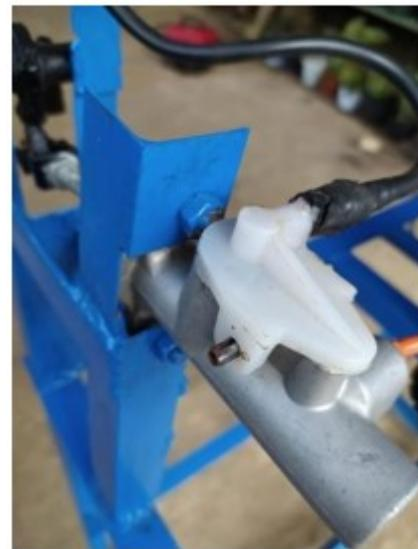
Gambar 8. Pemasangan Master Kopling Atas
