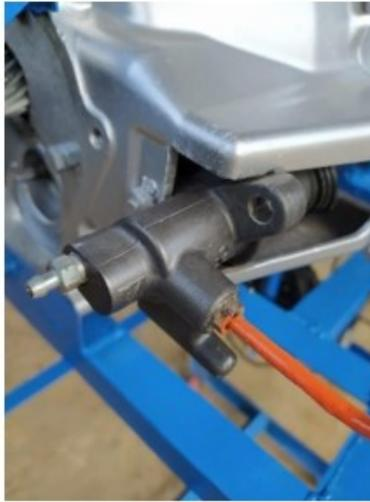
Gambar 9. Pemasangan master kopling bawah
