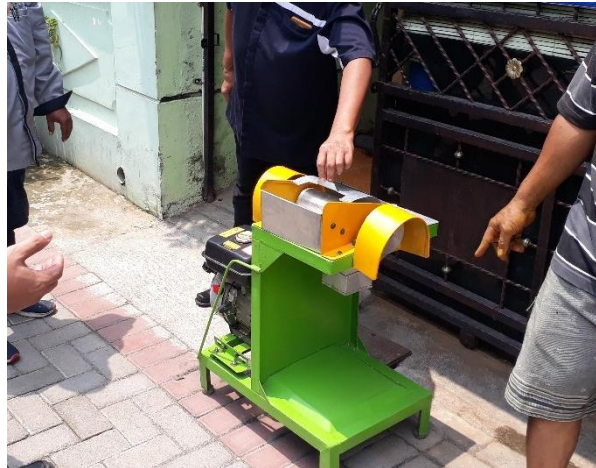
Gambar 3. Penggunaan mesin parut empon-empon semi-otomatis oleh mitra
