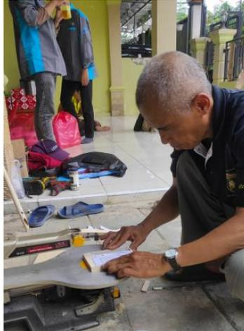
Gambar 3 Pemotongan Huruf/Angka dengan *Scroll Saw*
