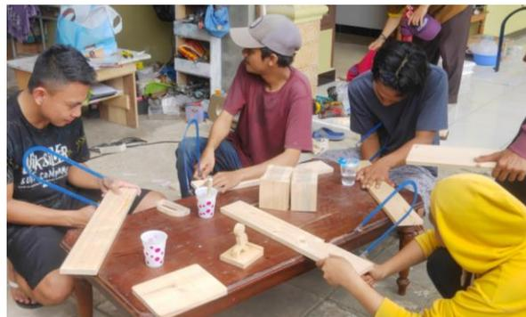
Gambar 4 Pemotongan Bentuk Nomor secara Manual dengan *Coping Saw*
