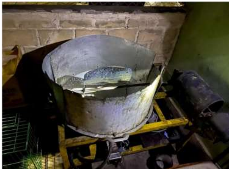
Gambar 2 Wajan dan Mesing Penggoreng Amplang
