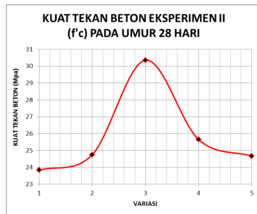
Gambar 4. Grafik hubungan antara Hasil kuat tekan beton Eksperimen II dengan komposisi agregat kasar Lebak Cilong
