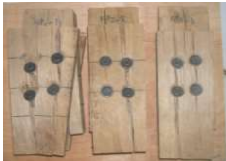
Gambar 3. Model Kerusakan Sambungan Kayu Kempas
