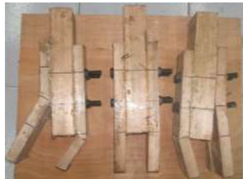
Gambar 5. Model Kerusakan Sambungan Kayu Meranti
