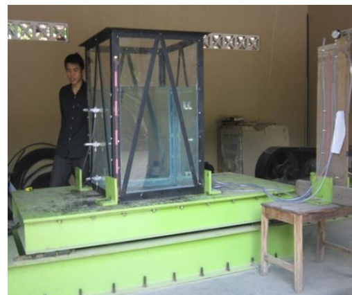
Gambar 3. Wadah benda uji yang sudah terpasang pada alat shaking table
