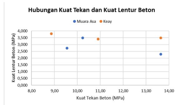
**Gambar 3.** Grafik Hubungan Pengujian Kuat Tekan dan Kuat Lentur Beton
