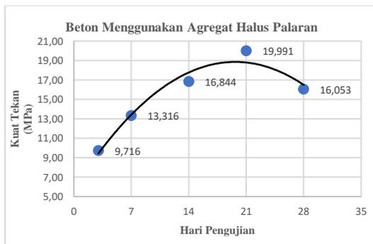
**Grafik 4.20** Pada pengujian kuat Tekan Beton Agregat Halus Palaran terjadi peningkatan dan penurunan. Pada beton umur uji 3 hari sebesar 9,716 MPa mengalami peningkatan berturut-turut sebesar 13,316 MPa, 16,844 MPa, dan 19,991 MPa. Pada beton umur uji 28 hari Terdapat penurunan sebesar 16,053 MPa.
