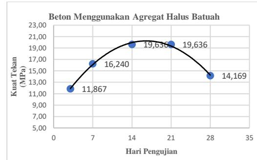
**Grafik 4.26** Pada pengujian kuat Tekan Beton Agregat Halus Batuah terjadi peningkatan dan penurunan. Pada beton umur uji 3 hari sebesar 11,867 MPa mengalami peningkatan berturut-turut sebesar 16,240 MPa, dan 19,636 MPa. Pada beton umur uji 28 hari Terdapat penurunan sebesar 14,169.
