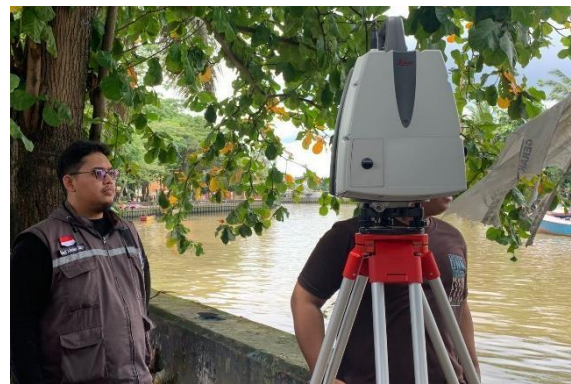
Gambar 3. Spesifikasi Peralatan Terrestrial Laser Scanner
