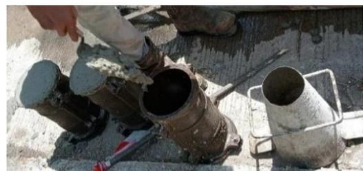
**Gambar 12.** Pembuatan Sampel Benda Uji
