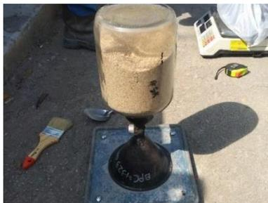
**Gambar 8.** Pengujian *Sand Cone*
