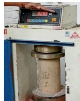
**Gambar 16.** Pengujian Mutu Beton
