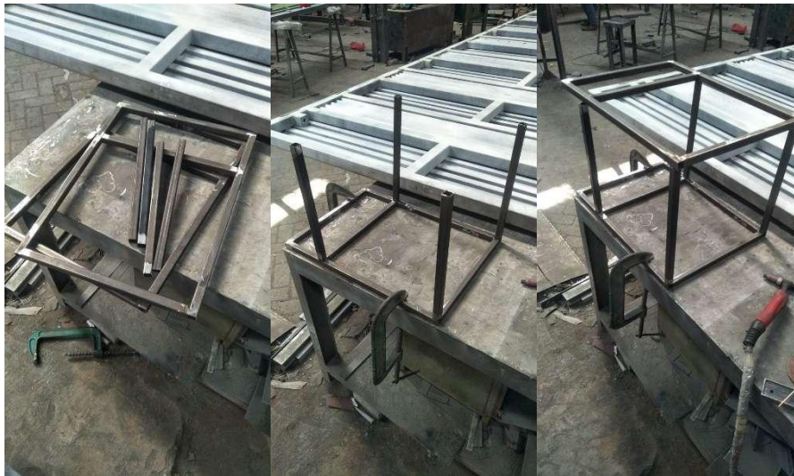
Gambar 12. Proses Assembling (perakitan)
