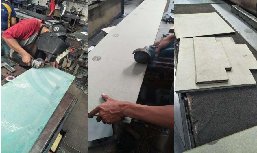
Gambar 13. Proses pemotongan MDF HMR
