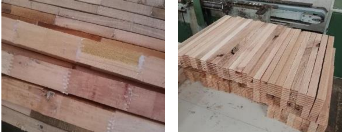
Gambar 5. Limbah kayu yang sudah berbentuk FJL
