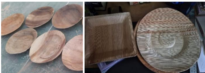
Gambar 4. Percobaan pertama dan kedua dengan material pelepah palem raja ( Sumber : Data Pribadi, 2025)
