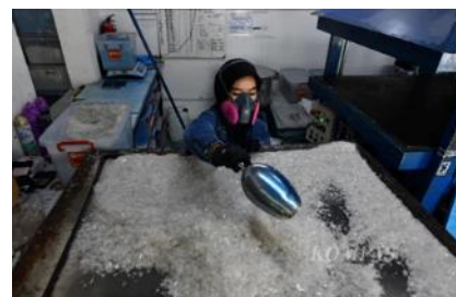
Gambar 14. Proses press cacahan plastik PP menjadi papan
