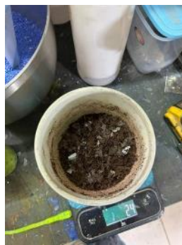
Gambar 7. Pencampuran ampas kopi dengan plasticizer dan cacahan plastik PP
