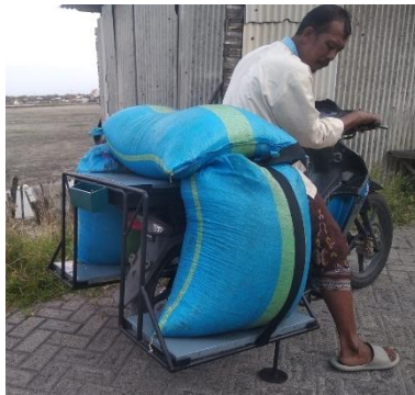
Gambar 12: Uji Coba Kaki Penyangga (Sumber : Data Pribadi 2022)
