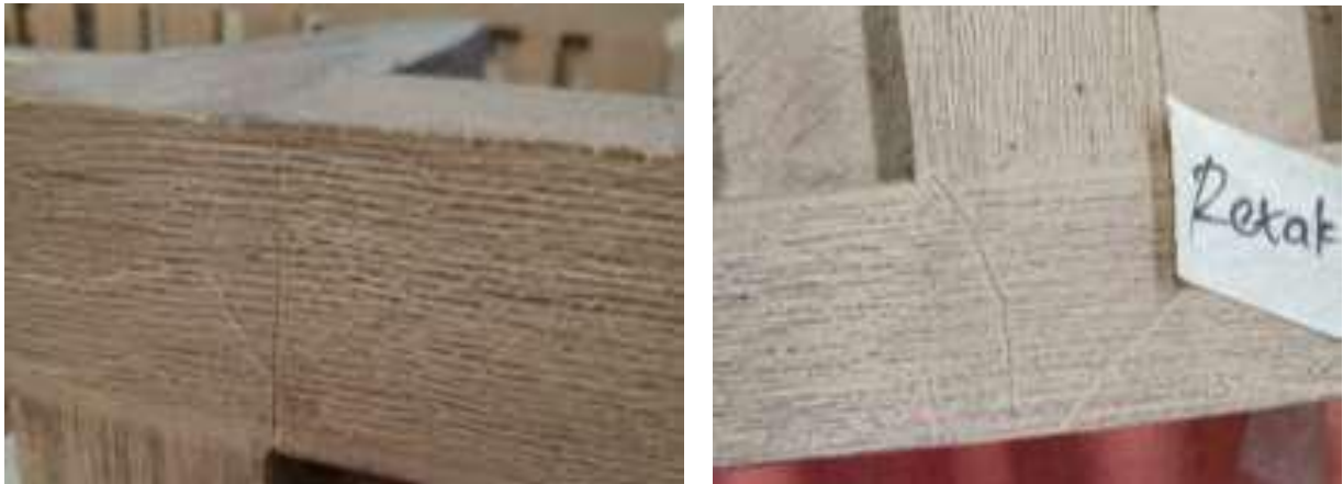
Gambar 2. Crack pada kaki depan dan kaki tengah
