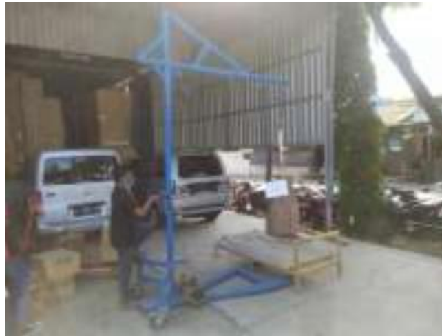
Gambar 1. Skema pengujian impact pada produk kursi outdoor
