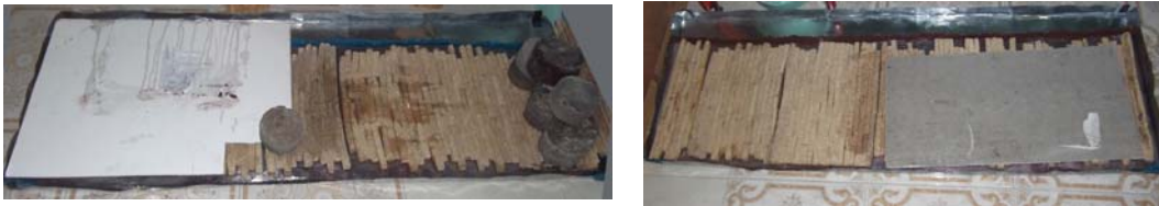
Gambar 15. Pelapisan Resin sebagai Penguat pada Bagian Bawah Papan Janggal Sumber : Ningroom Adiani, 2015
