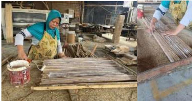
Gambar 13. Proses Pengolesan Lem dan Perekatan Pada Bilah Bambu
