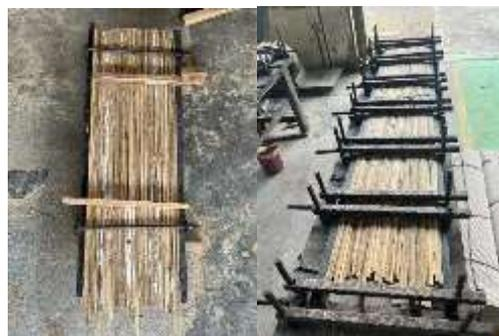
Gambar 14. Proses Press dengan Klem Besi
