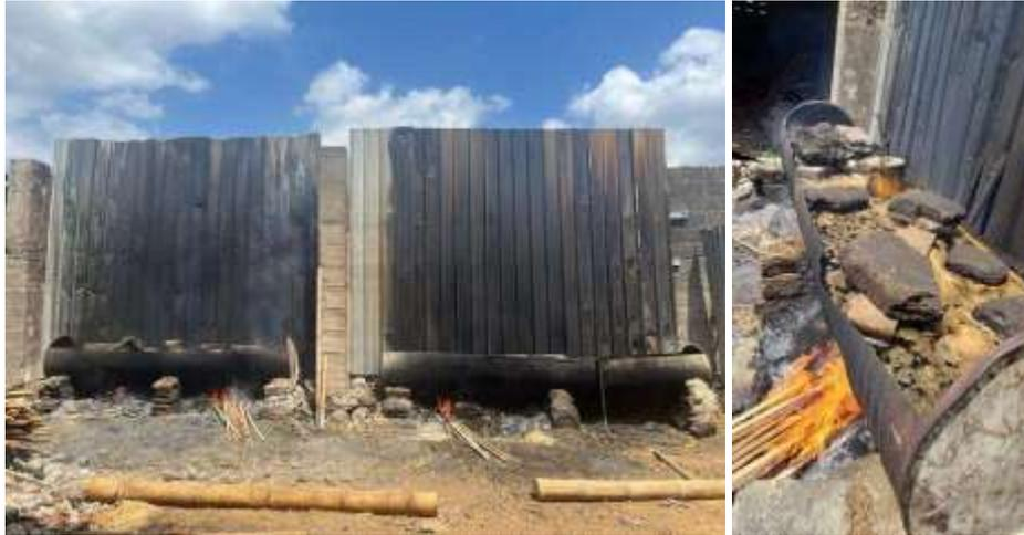
**Gambar 10.** Proses Pengawetan Bilah Bambu dengan Teknik Perebusan
