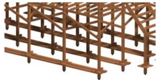
Gambar 6. Kolom panggung dengan penahan kalang menerus
