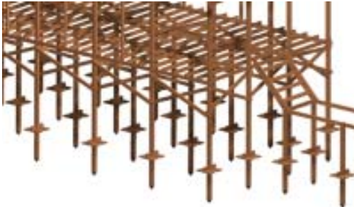
Gambar 4. Solusi kolom panggung/trucuk yang diperkuat dengan suai
