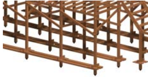
Gambar 5. Kolom panggung dengan penahan kalang menerus
