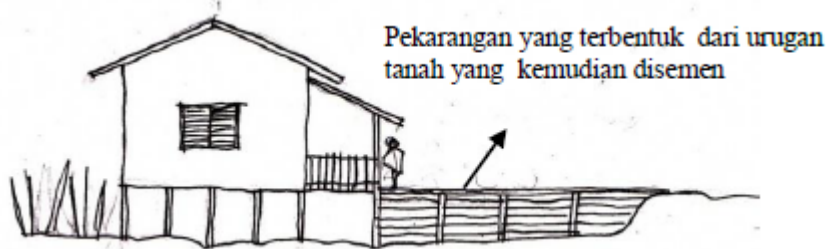
Gambar 9. Jembatan yang diganti urugan tanah dan semen tidak direkomendasikan
