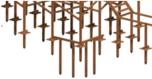
Gambar 7. Penambahan tiang pancang kayu ulin yang diikat ke kalang tambahan
