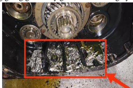
Gambar 3. fraktur pada auxlary gear
