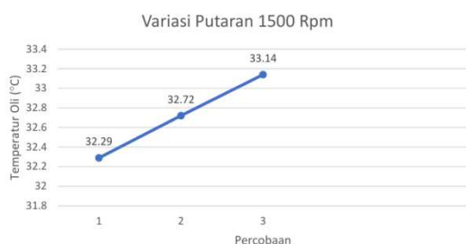
Gambar 4. Grafik Temperatur Oli Variasi 1500 Rpm
