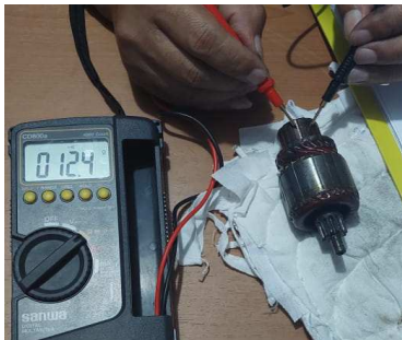
Gambar 2 Periksa Commutator Terhadap Sirkuit Terbuka
