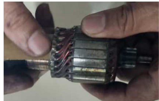
Gambar4 Amplas Commutator Menggunakan Amplas No 400
