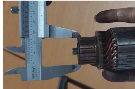
Gambar 7 Periksa Dalamnya Potongan Commutator
