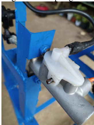
Gambar10 Pemasangan master kopling atas
