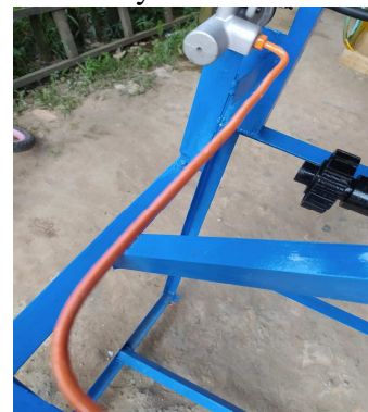
Gambar13 Pemasangan flexible hose
