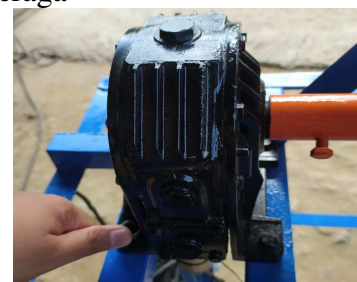
Gambar5 Pemasangan gear box pada dudukan
