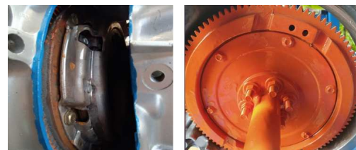
Gambar 4 Pemasangan kampas kopling ke fly wheel
