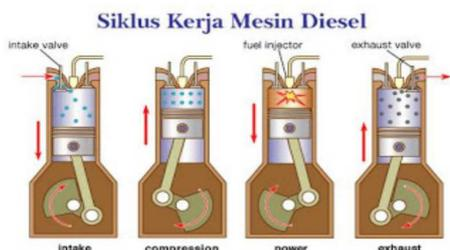
Gambar1. Silus Kerja Mesin Diesel
