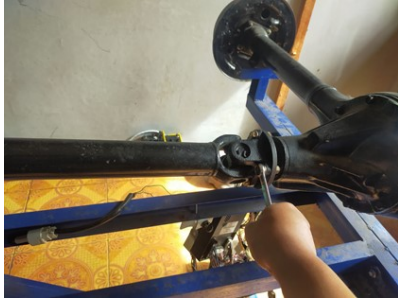
Gambar 3. Pemasangan Propeller Shaft.
