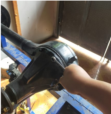
Gambar 3. Pemasangan Axle Housing/Gardan dan Tromol.
