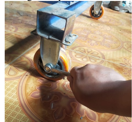
Gambar 3. Pemasangan Roda Stand.
