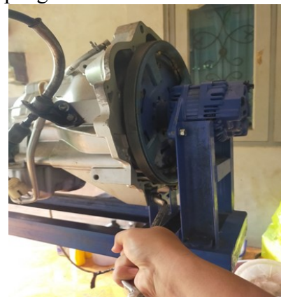
Gambar 3. Pemasangan Transmisi Matic.
