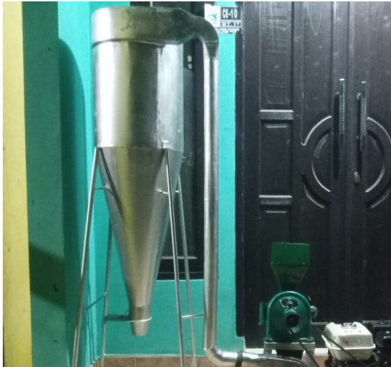
Gambar 5. Mesin Penggiling Kunyit Dengan Blower Penghisap Pada Ruang Giling
